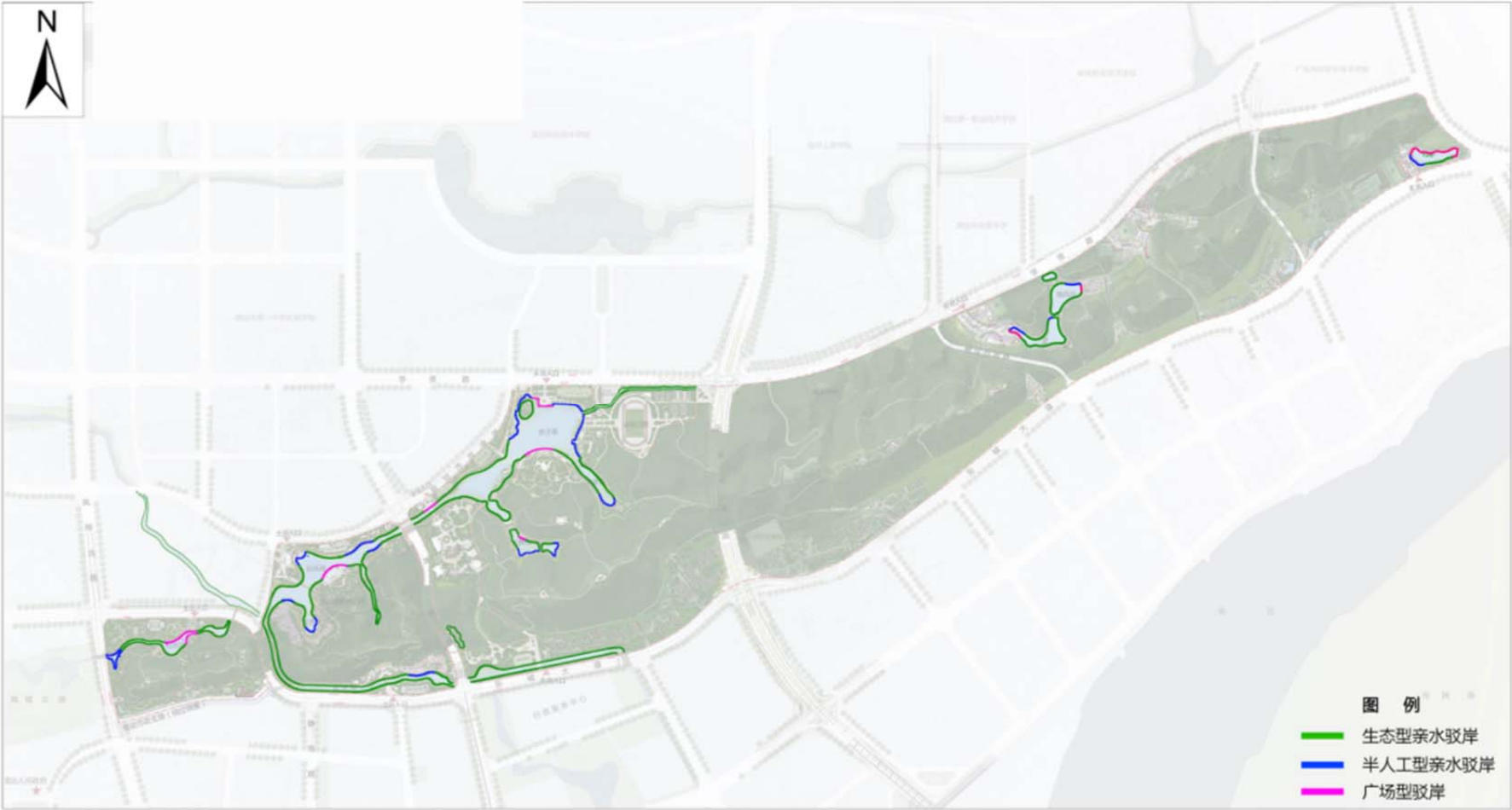
图 5-23 本项目各类水系驳岸布置规划图
