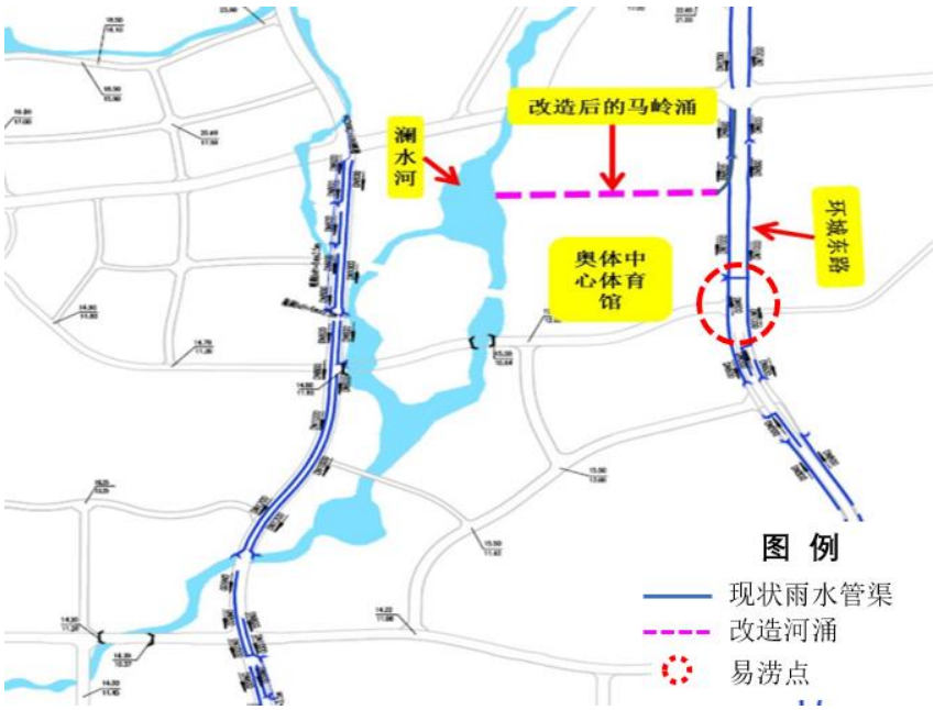
图 6-4 蟠龙围路西南侧易涝点整治措施图
