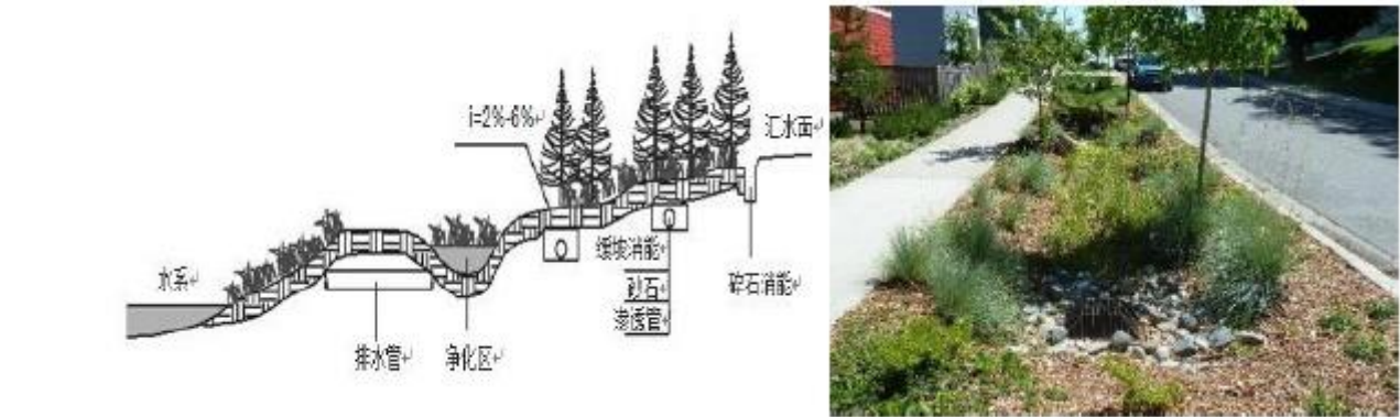
图 5-31 植被缓冲带构造及效果示意图
