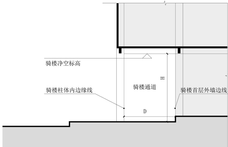
骑楼通道最窄处净宽 $D \geq 3.5$ 米，净高 $\geq 4.5$ 米。
