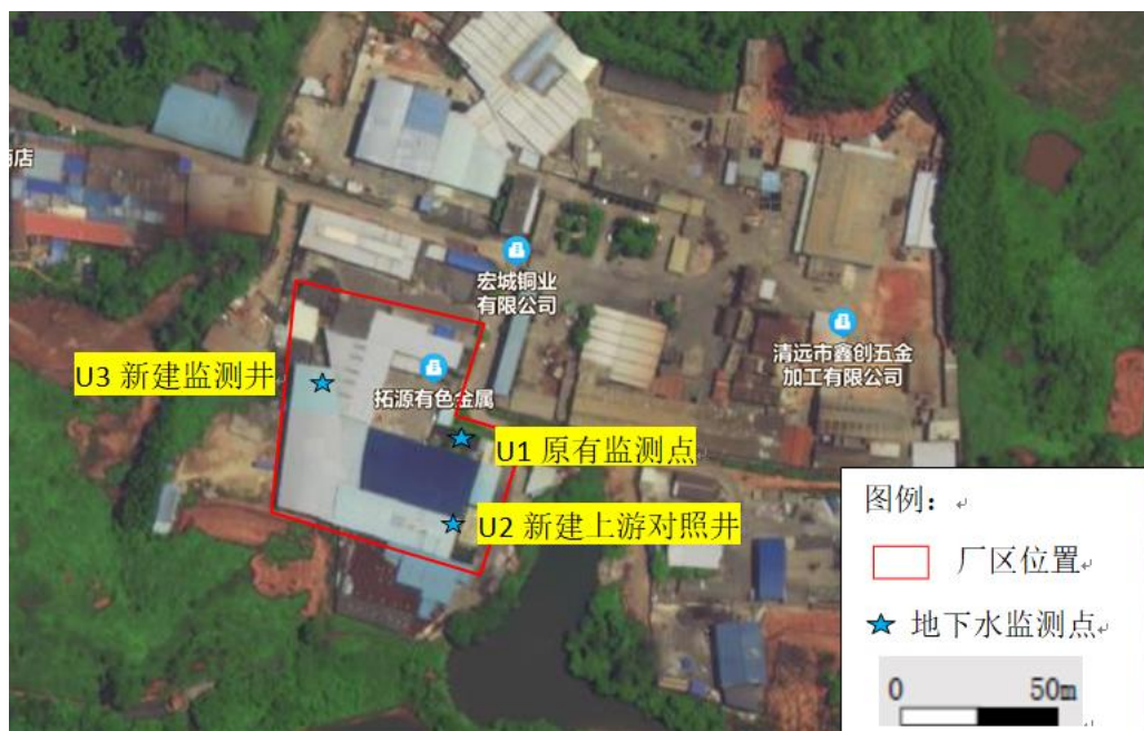
图4.1-2 现场地下水采样布点图
