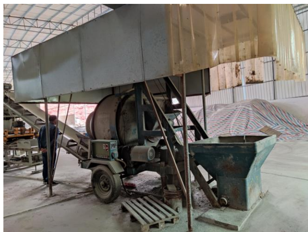
图 2.6-9 免烧砖投料系统集气罩
