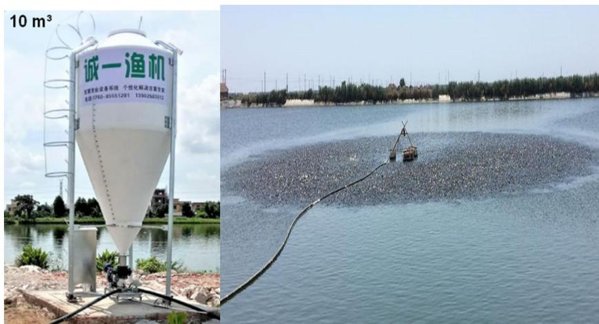
图 3 密封饲料仓和 360° 自动投料机实例
